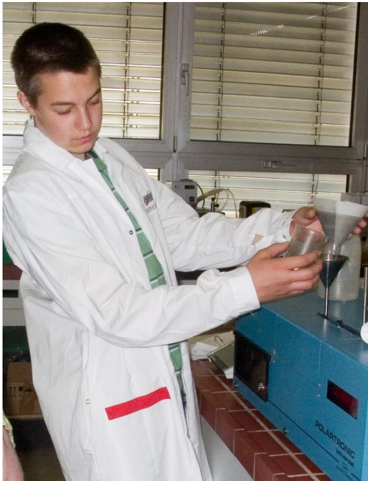
Im Labor der Zuckerfabrik Ochsenfurt Polarimetrische Messungen zur Bestimmung des Zuckergehaltes und photometrische zur Bestimmung des Kaliumgehaltes
